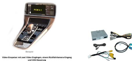
Beispiel Video-Einspeiser mit zwei Video-Eingängen, einem Rückfahrkamera-Eingang und CAN-Steuerung
