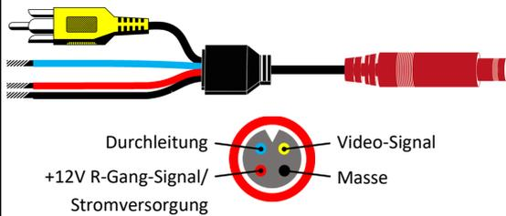
**Hinweis:** Bei Stromversorgung über Rückfahrleuchte empfehlen wir die Installation eines Relais zwischen Stromversorgung der Rückfahrleuchte und Kamerastromversorgung, um eine stabile und störungsfreie Stromversorgung zu gewährleisten und Telematik Fehlermeldungen zu vermeiden. Die **Durchleitung** kann benutzt werden um das Rückfahrsignal vom Heck nach vorne zu leiten.
